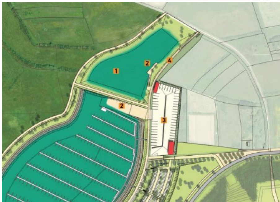
1 : base nautique ; 2 : rampe de mise à l'eau ; 3 : aire de carénage ; 4 : promenade du port (Source : Etude d'impact, p. 33)
